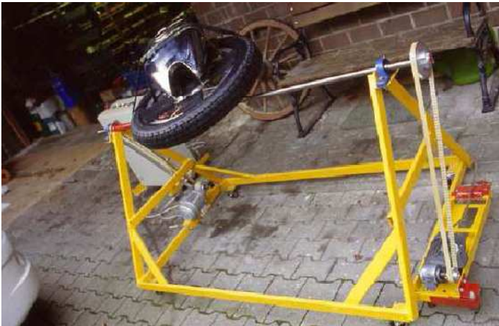
Gleitschleifmaschine mit Steuerteil für PKW-Tanks oder Motorradtanks.
