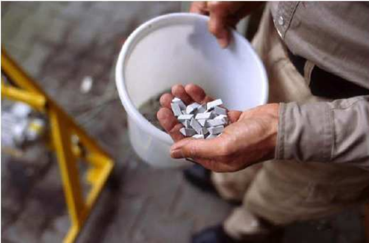
Trovaliersteine aus Keramik oder Kunststoff mit eingebundenem Schleifmittel, z.B. hier in Pyramidenform.
